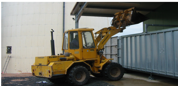
Figura 11: Carga del contenedor dosificador de sustrato
