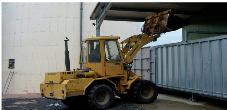
Figura 11: Carga del contenedor dosificador de sustrato
