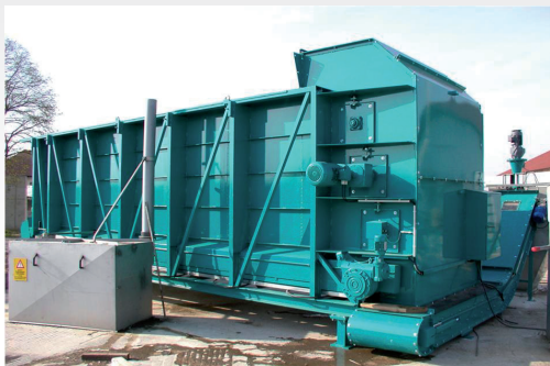
Figura 15: Sistema de alimentación con contenedor de piso móvil y tornillo sin fin
