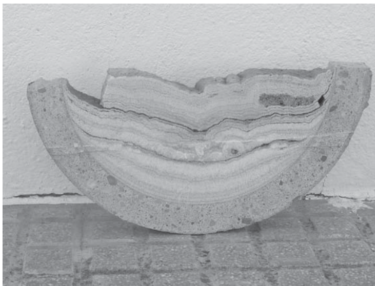
Figura 6.4. Conducción de agua con deposiciones calcáreas debidas al efecto de aguas incrustantes (precipitación de \text{CaCO}_3 ).
