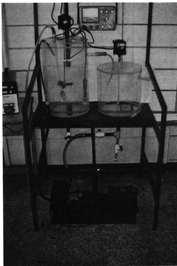
Foto V.1. Equipo semipiloto de lodos activados para el tratamiento de aguas residuales
